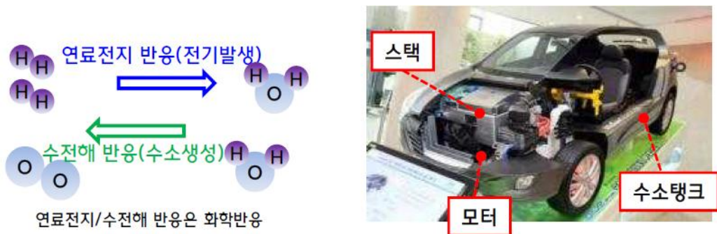
[그림 10] 수소연료전지 자동차의 구조와 원리
