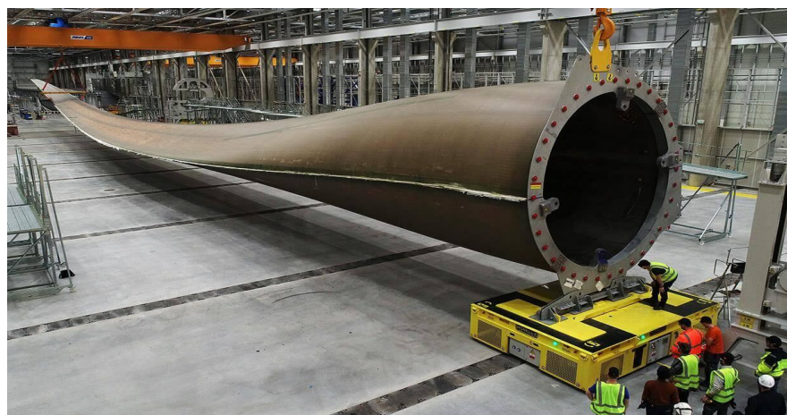
[그림 3] GE자회사 LD Wind Power사가 개발한 계에서 가장 긴 블레이드(107m)
