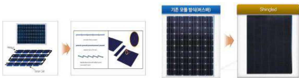
[그림 6-7] 기존 버스바 방식과 쉐글드 방식 모식도
